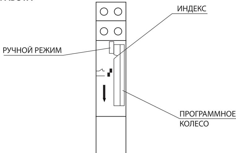
Реле размещено в пластмассовом корпусе. Под прозрачной крышкой лицевой панели находятся переключатель ручного/автоматического режима, программное колесо с движочками и индекс (указатель) текущего времени.
