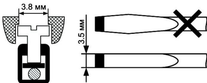
Момент затяжки винтового соединения должен составлять 0,4Нм
