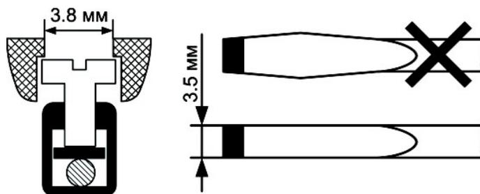
Момент затяжки винтового соединения должен составлять 0,4Нм
