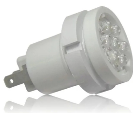
Лампа ЛСО-14 для установки в отверстие Ø22мм, контакт винтовой M3
