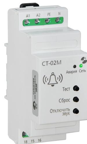
Произведите подключение сигнализатора тревог — реле контроля изоляции СТ-02М согласно схеме подключения: N — нейтраль, PE — заземленный корпус оборудования, 15 — переключающий контакт, 16 — нормально замкнутый контакт, 18 — нормально разомкнутый контакт реле для управления внешними устройствами; A1 и A2 — питание сигнализатора.
