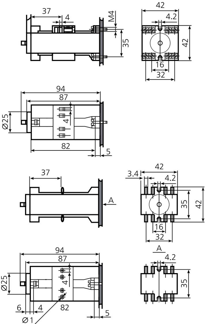
Исполнение для выступающего крепления с передним присоединением монтажных проводов винтовыми зажимами.
