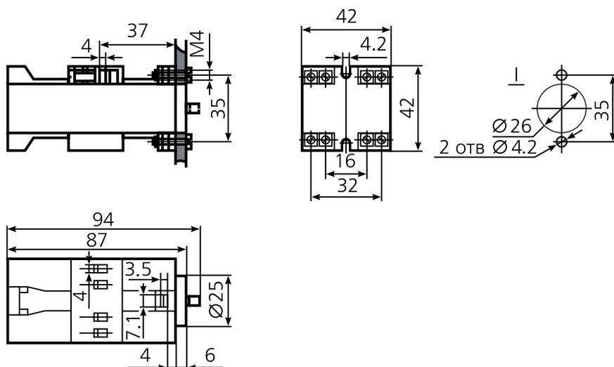
Исполнение для утепленного крепления с задним присоединением монтажных проводов винтовыми зажимами.
