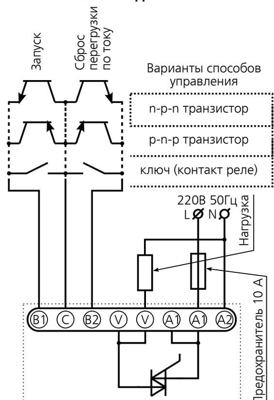
**СХЕМА ПРИМЕНЕНИЯ СБ-10М ДЛЯ ПОДКЛЮЧЕНИЯ ТРЕХФАЗНОГО ЭЛЕКТРОДВИГАТЕЛЯ К СЕТИ**
