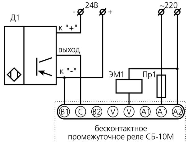
Pr1 – плавкий предохранитель (номинал – не более 10А)
