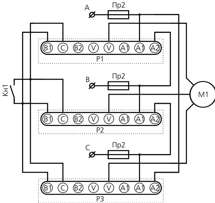
P1...P3 – бесконтактные промежуточные реле СБ-10М
