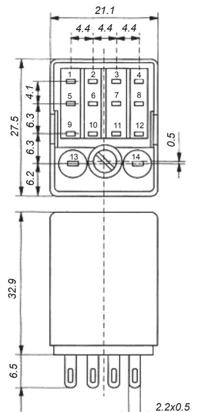
Габаритные размеры реле R-4.
