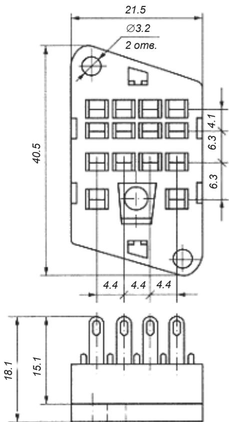
Габаритные, установочные и присоединительные размеры розетки реле R-4 с присоединением проводников пайкой.
