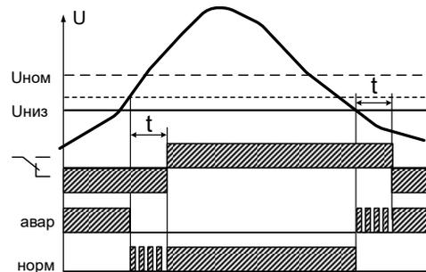
Рис. 2в. Реле минимального напряжения "Уверх выкл"
