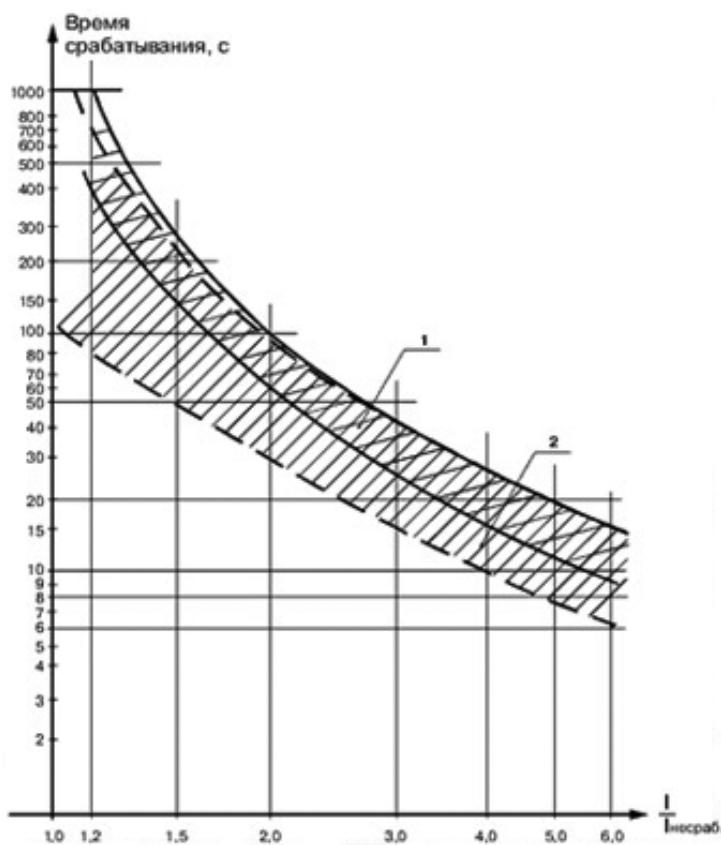
1 - зона времятоковых характеристик при трехполюсной работе реле
