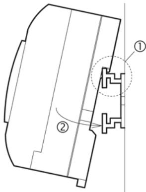
Совместите верхний край канавки, имеющейся на корпусе контроллера серии "Альфа-2", и предназначенной для монтажа на рельсе в стандарте DIN, с краем рельса (1), и надвиньте устройство на рельс.
