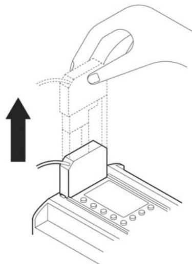
4) Установка на место крышки или кассеты запоминающего устройства
