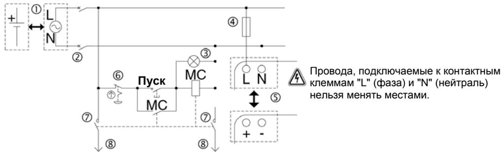
⚠ Провода, подключаемые к контактными клеммам "L" (фаза) и "N" (нейтраль) нельзя менять местами.
