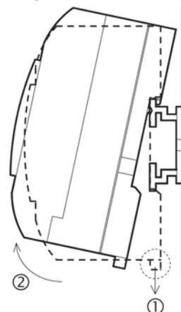
Оттяните вниз крючок зацепления с рельсом в стандарте DIN (1), и отсоедините главный блок серии "Альфа-2" от рельса (2).
