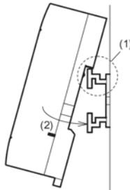
1) Устройства можно монтировать на защелке, при помощи крепления к 35 – миллиметровому рельсу в стандарте DIN (DIN EN 50022). Для отсоединения, оттяните подпружиненные защелки в сторону от рельса, и снимите устройство с рельса, сдвинув его вверх.
