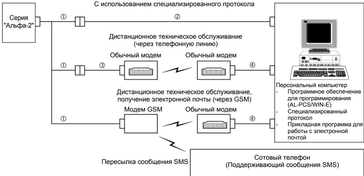
Таблица 8.1: Конфигурация системы при использовании кабеля AL2-GSM-CAB
