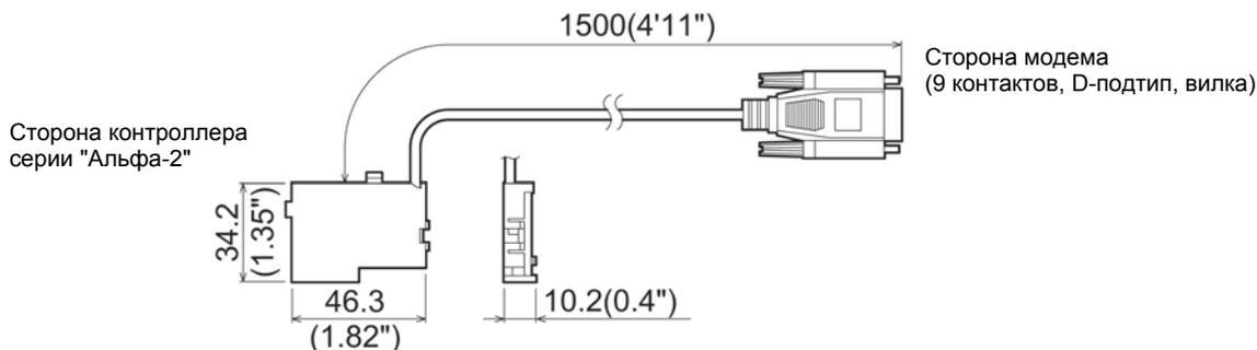
8.1.2 Конфигурация системы при использовании кабеля AL2-GSM-CAB
