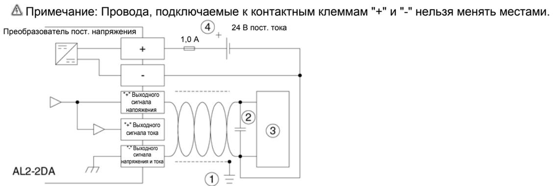
**Рисунок 11.4: Электрические соединения в режиме выходного сигнала тока**
