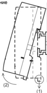
3) Для отсоединения Оттяните вниз крючок зацепления с рельсом в стандарте DIN (1), и отсоедините модуль AL2-2PT-ADP от рельса.
