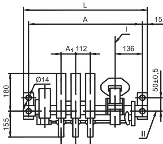
**Рисунок В.5** Габаритные и установочные размеры двух- и трехполюсных контакторов типа КТ, КТП 6000 на ток 630 А.
