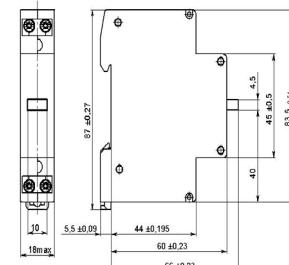
Рисунок Б.1 – Габаритные, установочные и присоединительные размеры кнопки управления типа OptiDin KM63-А и OptiDin KM63-AB
