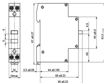
Рисунок Б.3 – Габаритные, установочные и присоединительные размеры кнопки управления типа OptiDin KM63-C и OptiDin KM63-CF
