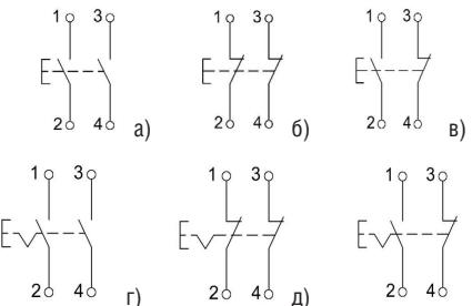
Рисунок В.1 – Принципиальные электрические схемы кнопки управления типа OptiDin KM63-А и типа OptiDin KM63-AB:
