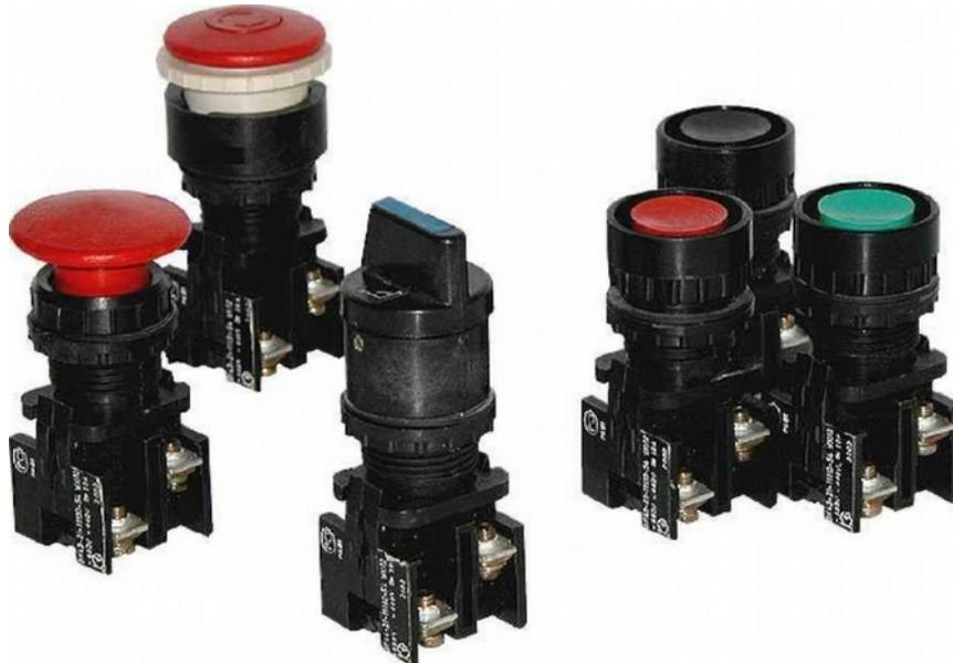
Выключатели кнопочные серии ВК43 и переключатели кнопочные серии ВК44 предназначены для коммутации электрических цепей управления переменного напряжения до 660 В частоты 50 и 60 Гц, постоянного напряжения до 440 В.
