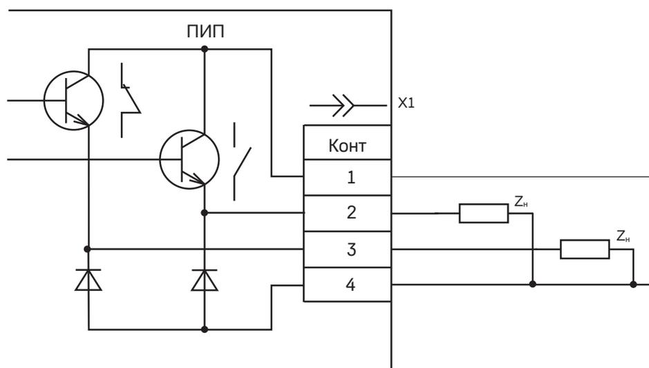
Схема подключения преобразователя ПИП:
