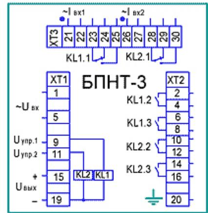
Для обеспечения надежной работы блока при всех видах К.З. токовые входы должны включаться на разность токов фаз А и С. Одноименные зажимы токовых цепей обозначены точкой.
